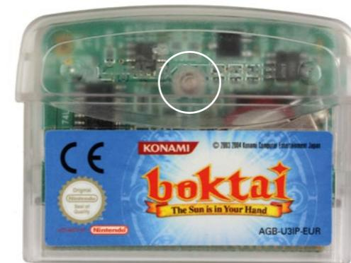
Die Kassette des Spiels *Boktai* verfügt über einen Lichtsensor, über den die Energie des virtuellen Helden aufgeladen werden kann.
